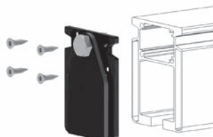
SPX049 Plaque de sécurité d'insertion des poulies
